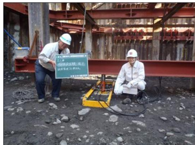
土工事（建物支持地盤確認）施工状況
